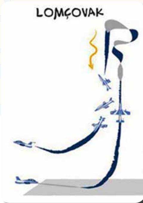
Si tratta di una manovra unica per un velivolo a propulsione a getto e di esecuzione estremamente soggettiva, in quanto gli avvitamenti sono controllati in maniera istintiva per sfruttare gli accoppiamenti giroscopici del motore ed evitare la divergenza del velivolo dalla traiettoria desiderata.
