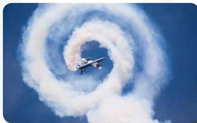
**GIBI MOLINARO** prosegue il racconto, spiegando come si esegue la figura: *"L'ingresso è una richiamata, aeroplano 'in piedi', in verticale, si inizia una rotazione a sinistra, cioè un tonneau a sinistra, per far acquisire una certa inerzia di rotazione alla macchina."*
