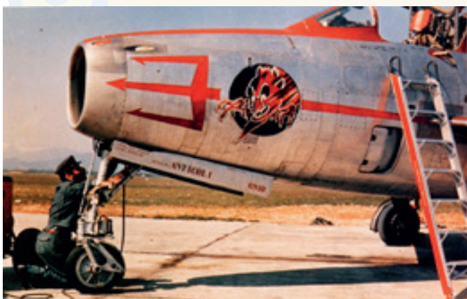
Capo-velivolo durante un'ispezione al vano carrello
