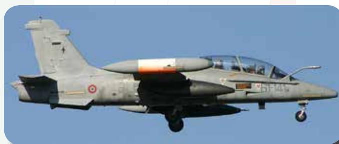
Questa versione era caratterizzata, oltre che dall'adozione di un *motore Rolls Royce Viper 680 da 2080 Kg di spinta*, da una sostanziale revisione dell'avionica e della cabina di pilotaggio che diventava interamente digitale con tre schermi multifunzione e dotato di due Head-up Display (HUD) per entrambi i Piloti.
