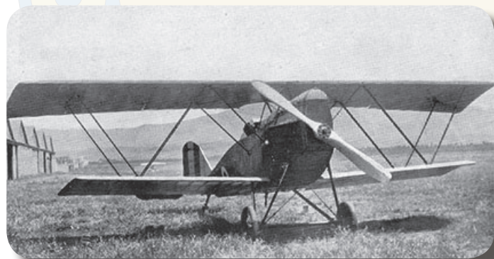
SVA con motore SPA 6-A da 205 CV
