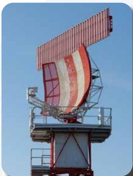
Il radar primario rileva la posizione di un aeromobile trasmettendo e rilevando un segnale elettromagnetico tramite un'antenna, il radar secondario gli impulsi trasmessi dai transponder degli aeromobili in modo che il controllore abbia sempre visione della posizione esatta del velivolo e dei suoi dati di volo.
