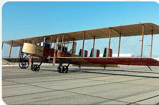
*Nel 1914 il Caproni con 3 motori Isotta Fraschini da 300 CV fu adottato dalla nostra Aviazione Militare quale apparecchio da bombardamento e fu il primo tipo di concezione italiana che prese parte alla guerra.*
