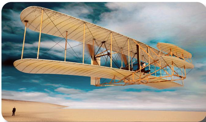
Per guidare il Flyer il pilota era disteso bocconi con la testa in avanti e con la mano sinistra sul controllo di cabrata. Il controllo laterale era ottenuto inclinando le estremità delle ali in senso opposto tramite fili attaccati ad una intelaiatura di sostegno fissata sull'ala più bassa. Il pilota spostava l'anca da una parte e dall'altra per azionare il meccanismo che controllava anche il timone.
