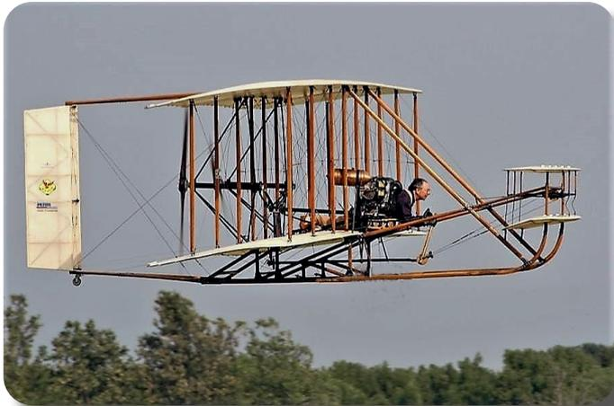
sganciate lasciando poi la possibilità di atterrare sulla struttura arcuata a forma di pattini.
