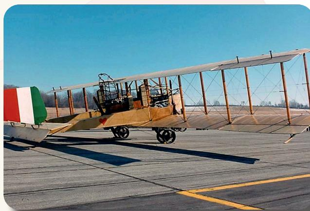
*Il Ca 3 aveva due posti di pilotaggio e due mitragliatrici Fiat 14 calibro 6.5 x 52, una in prua ed una sul retro dell'ala, sopra l'elica posteriore. Poteva trasportare un carico di bombe di 300 kg.*
