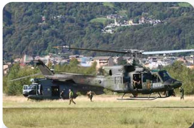
L'HH-212A è un elicottero medio con rotore a due pale mosso da due turbine Pratt & Whitney PT6T da 1.342 Kw. È derivato sostanzialmente dal modello 205 da cui si differenzia per la fusoliera allungata. L'Aeronautica Militare acquistò i primi tre esemplari nel 1979 per il poligono di Decimomannu (Cagliari), dove furono inquadrati nella 670<sup>a</sup> Squadriglia del Reparto Standardizzazione e Sperimentazione Tiro Aereo.
